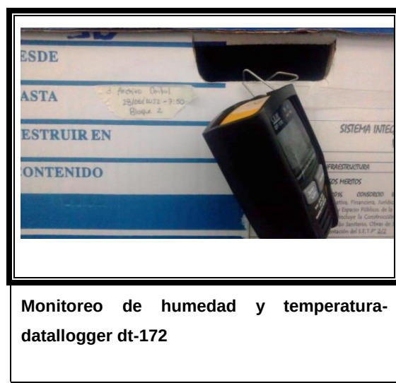
Ilustración 9 Monitoreo de humedad y temperatura- datalogger
